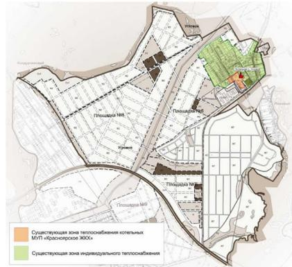
Рисунок 17 - Зона действия существующей системы централизованного теплоснабжения п. Угловой
