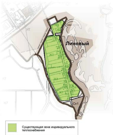
Рисунок 38 - Существующая зона действия индивидуальных источников тепловой энергии п. Линевоы
